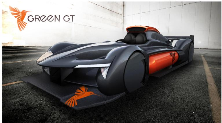
Pour satisfaire au règlement et aux normes de sécurité, un châssis spécifique a été conçu. La carrosserie, la double coque et la crash box sont réalisées en fibre de carbone :
